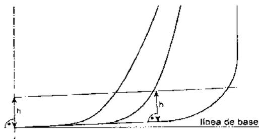
**Figura 3 - Definición de los límites de los tanques de carga a efectos del párrafo 6 de la presente regla**
