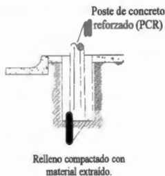
Ilustración 4. Poste de concreto en banqueteta
