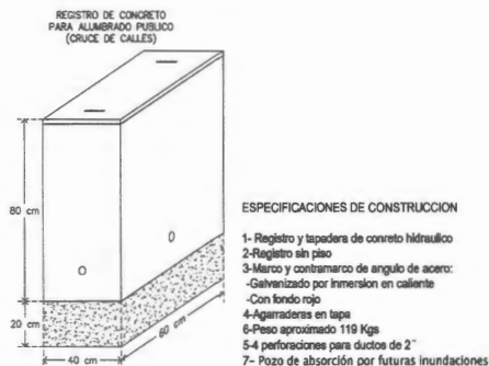
Ilustración 17. Registro de concreto prefabricado para cruce de calles.
