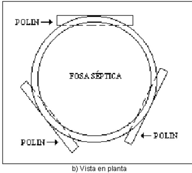
**FIGURA 3. COLOCACION DE FOSA SEPTICA VERTICAL SOBRE POLINES DE MADERA**
