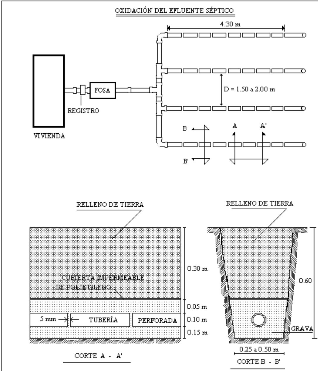
**FIGURA 7. ZANJAS DE INFILTRACION**
