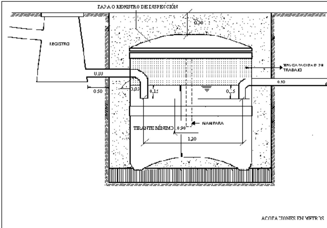
**FIGURA 2. FOSA SÉPTICA PREFABRICADA**
