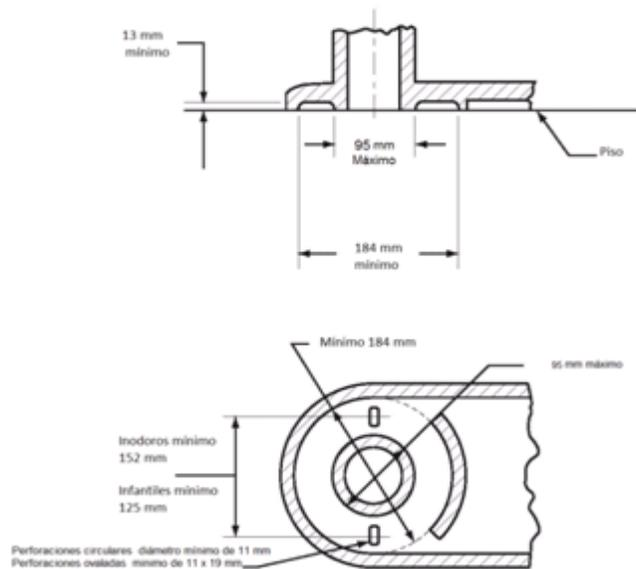
**NOTA 1.** - Esta Figura no pretende restringir el diseño de las bases de las tazas de inodoro, siempre y cuando se mantengan sus dimensiones para asegurar un intercambio adecuado entre inodoros.
