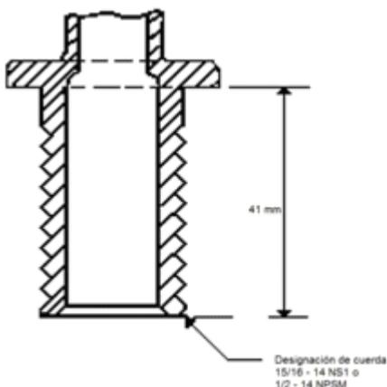
**Figura 13.-** Dimensiones de la válvula de admisión.
