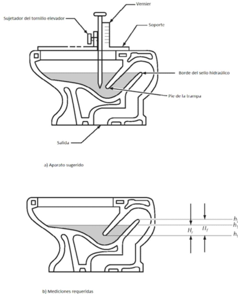
**NOTA 5** - El diagrama a), muestra el sello hidráulico con profundidad completa, el diagrama b), muestra el sello hidráulico parcialmente lleno.
