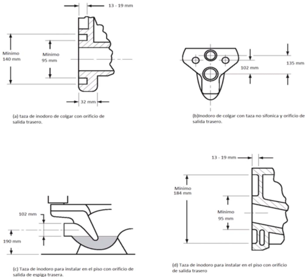
**NOTA 2** - Esta Figura no pretende restringir el diseño de las bases de las tazas de inodoro, siempre y cuando se mantengan sus dimensiones para asegurar un intercambio adecuado entre la instalación de diversos modelos inodoros.
