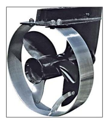
El protector de Hélice o guardahélice es un dispositivo utilizado por las embarcaciones para evitar lesionar a las ballenas
