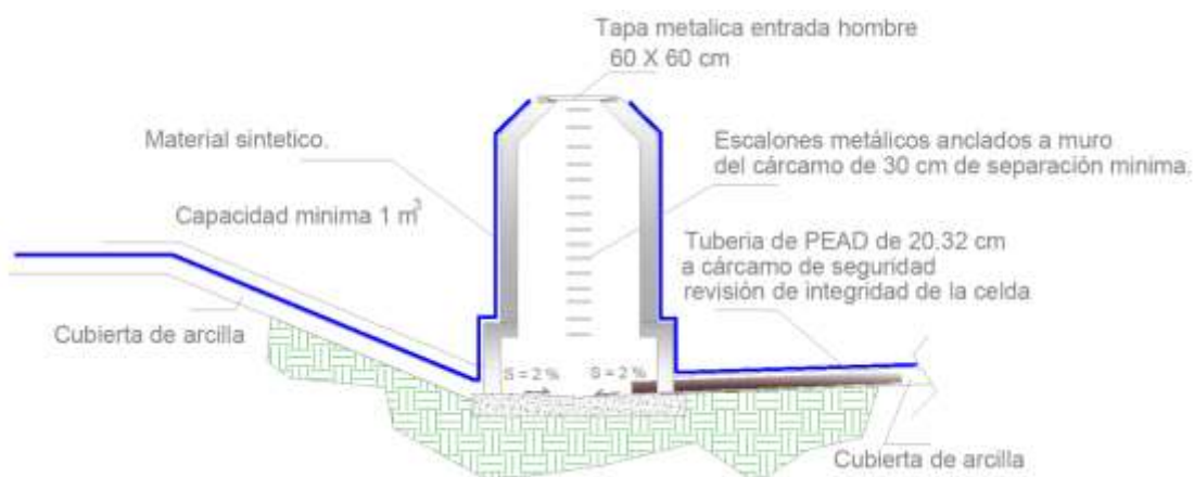
Figura A.5. Vista superior del pozo de monitoreo en vertical para lixiviados
