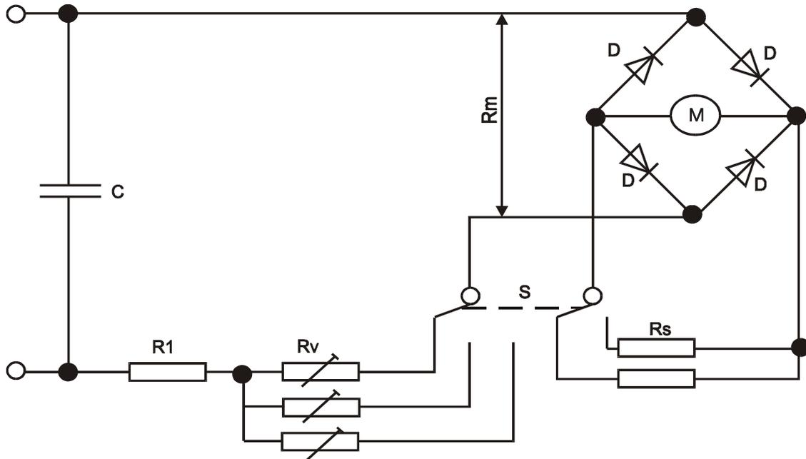
**Figura 1. Circuito para medir corriente de fuga**
