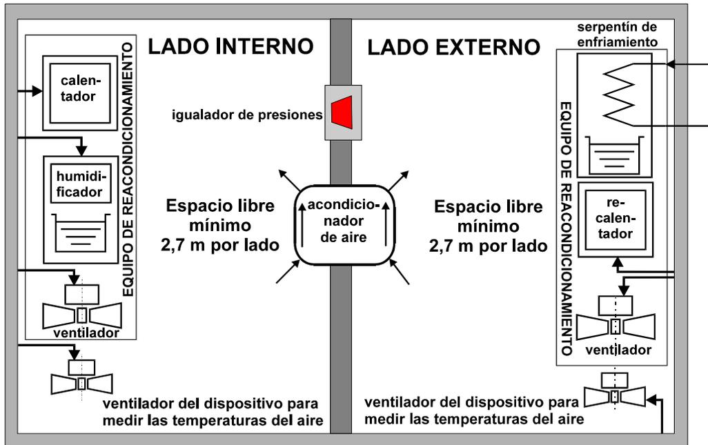
**A.2 Calorímetro de cuarto tipo calibrado**
