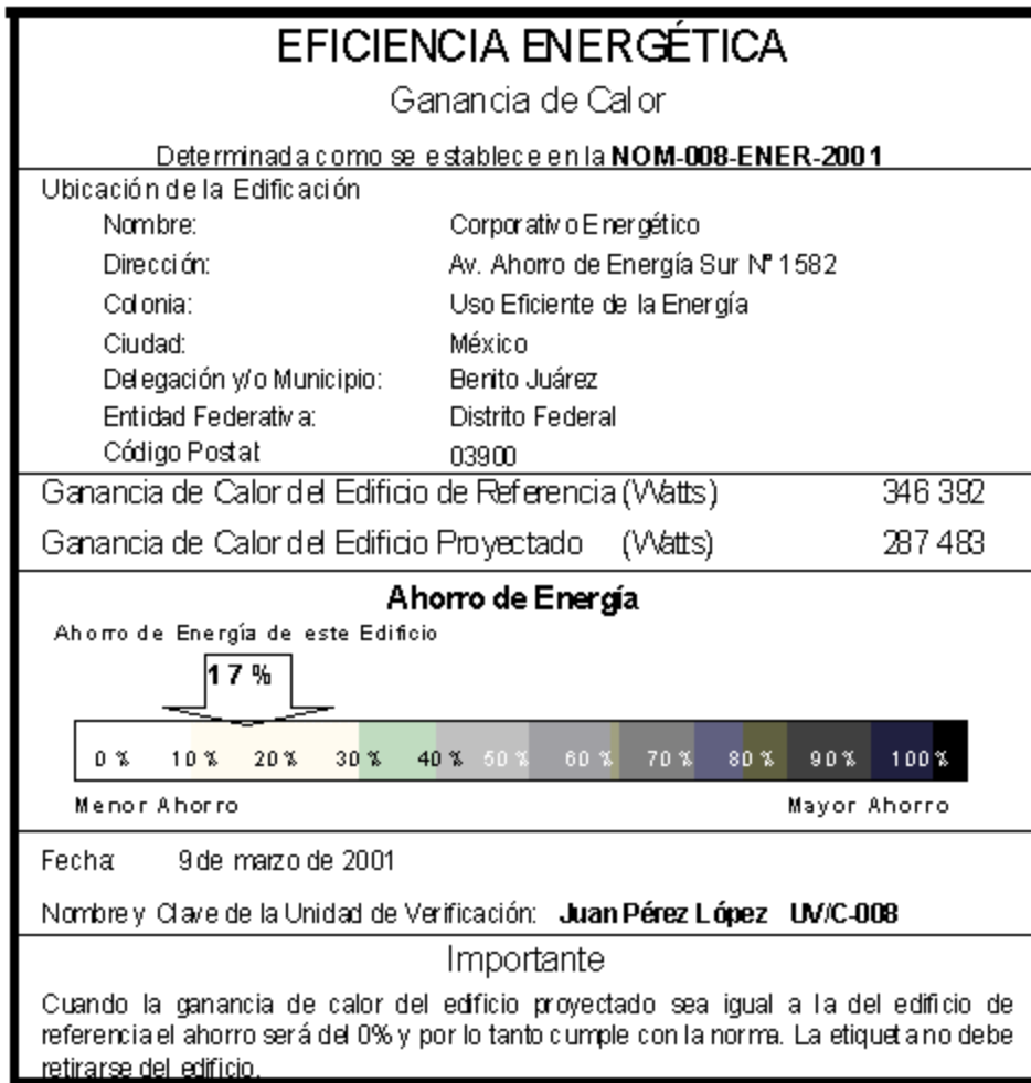
Figura 1. Ejemplo de distribución de la información de la etiqueta de la envolvente de los edificios no residenciales
