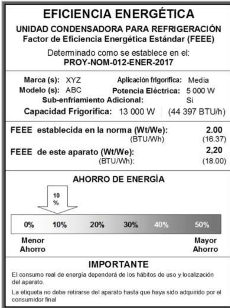
**Figura 10.1** Etiqueta de eficiencia energética para condensadoras
