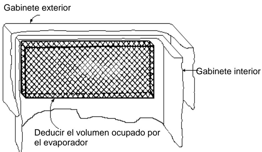
Figura 26. Volumen ocupado por el evaporador en sistemas de aire forzado
