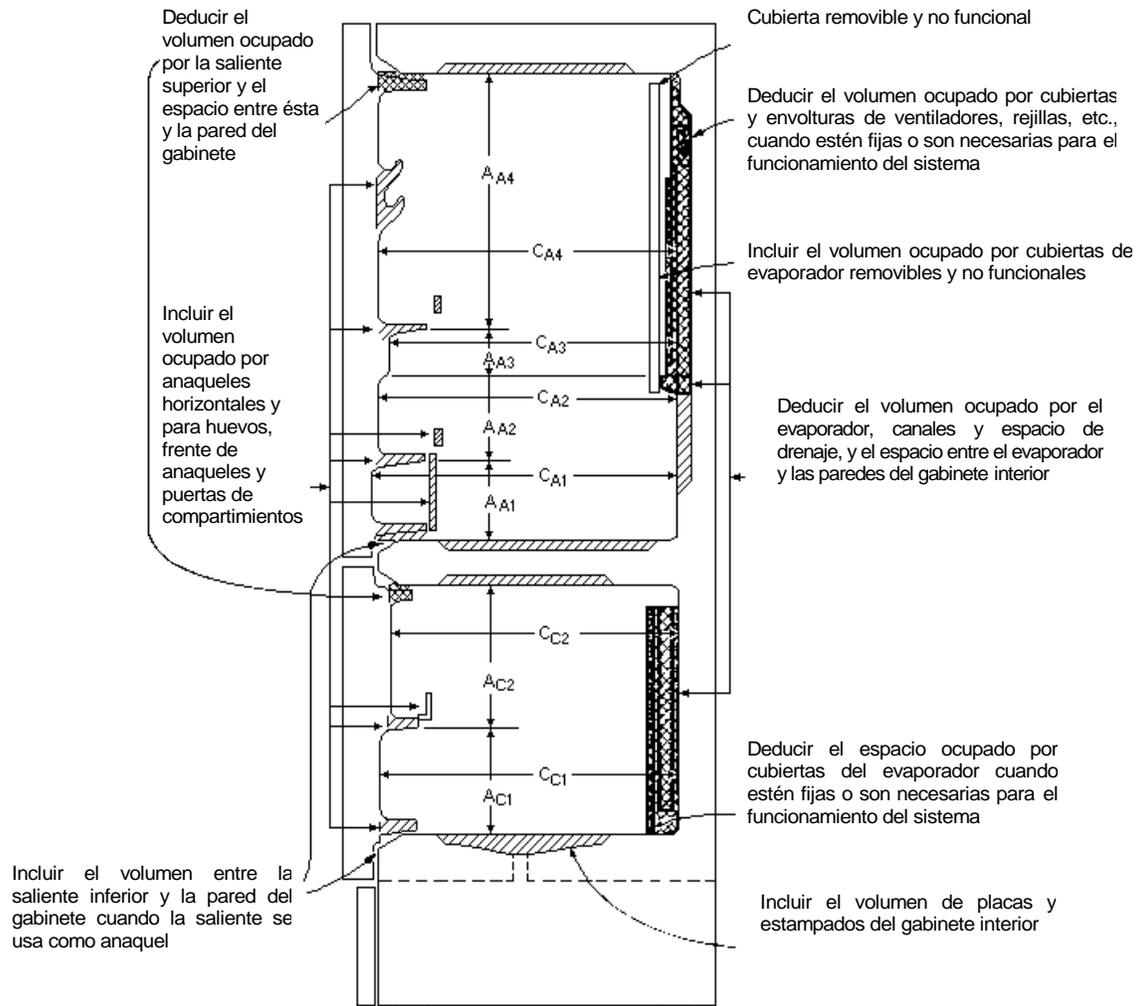
**Figura 9. Refrigerador-congelador con el compartimento congelador montado en la parte inferior.**
