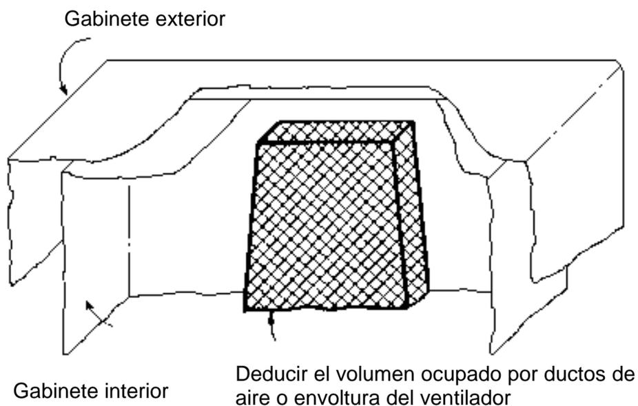
Figura 25. Volumen ocupado por ductos de aire
