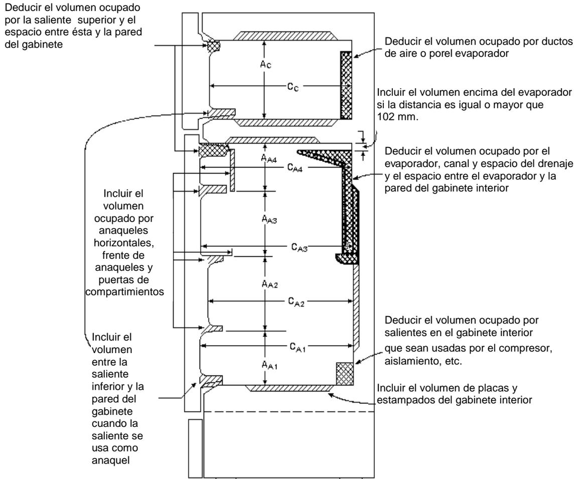
**Figura 8. Refrigerador-congelador con el compartimento congelador montado en la parte superior.**
