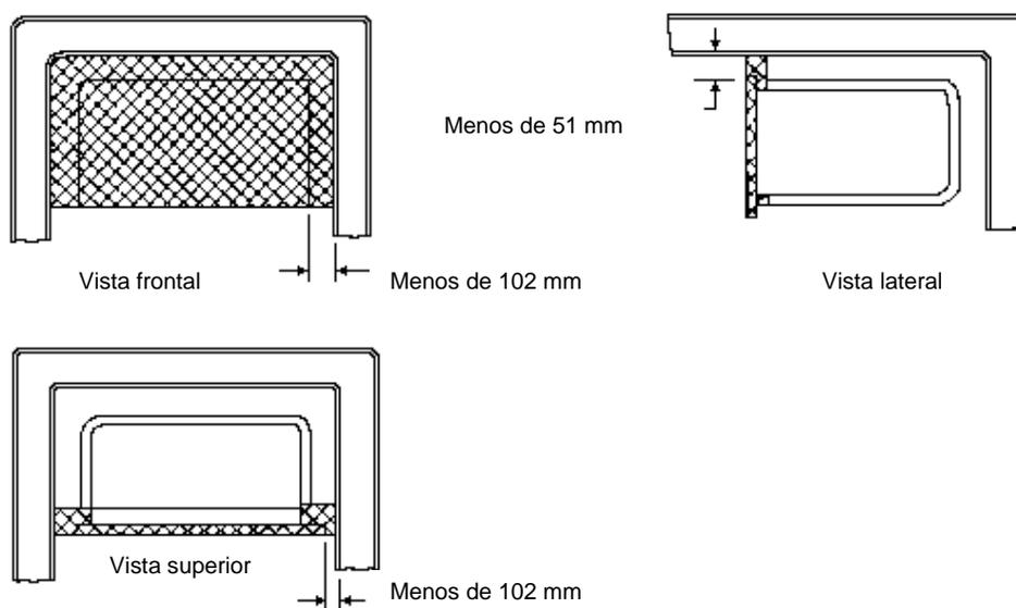
**Figura 13. Deducciones de la puerta del evaporador.**
