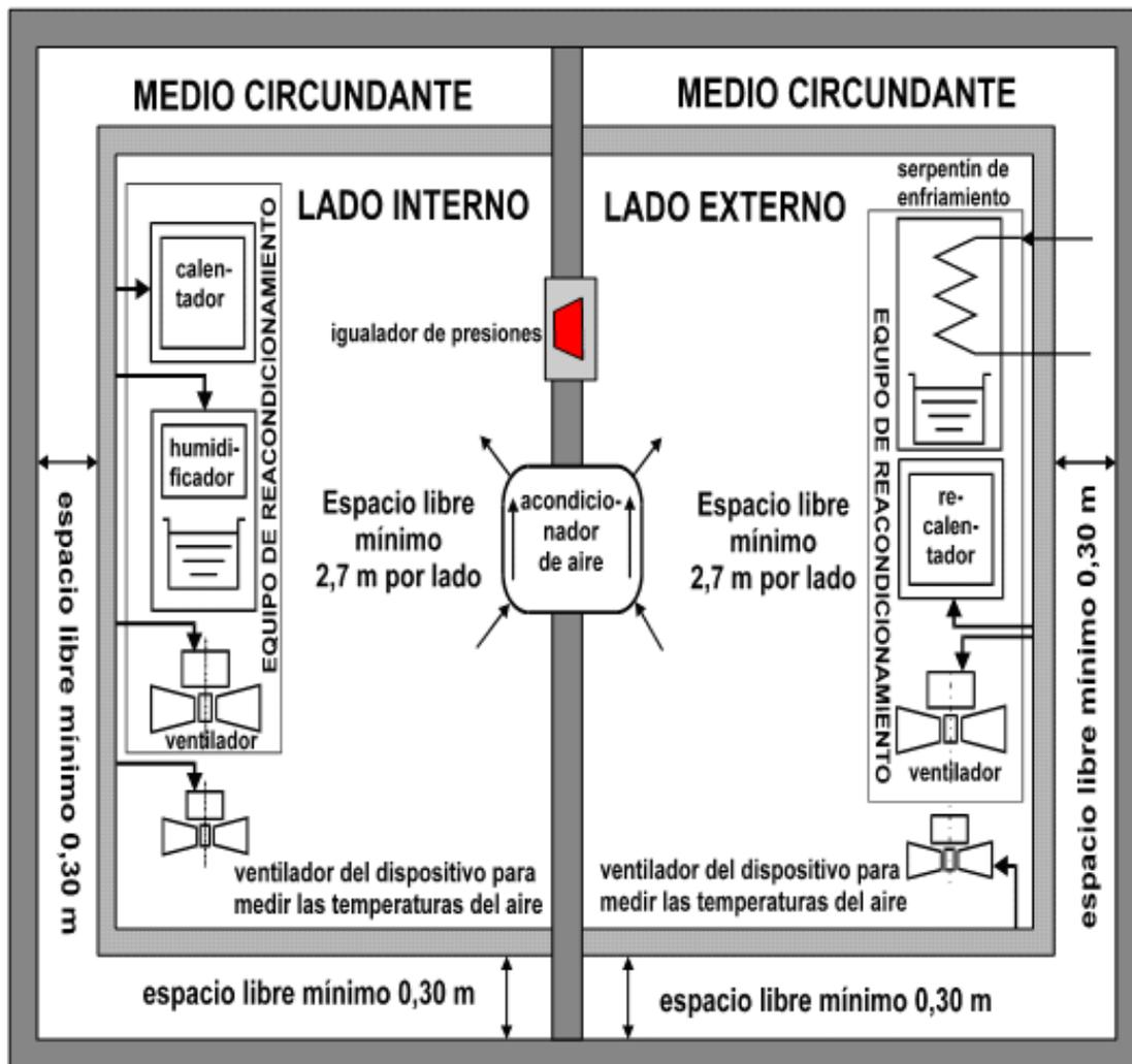
Figura 1. Calorímetro de cuarto tipo ambiente balanceado
