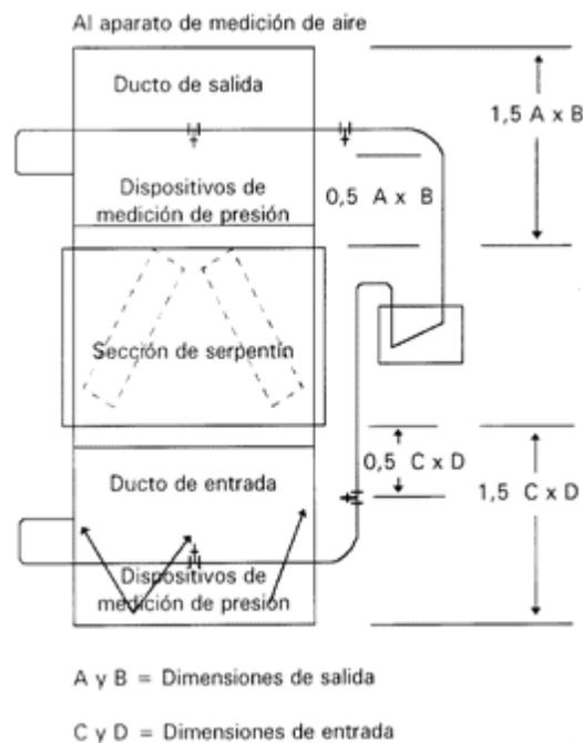
FIGURA 9. Aparato alternativo para medición del flujo de aire
