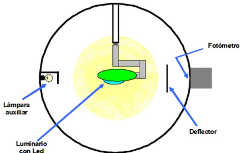
Figura F2. Configuración de la esfera integradora 2TT
