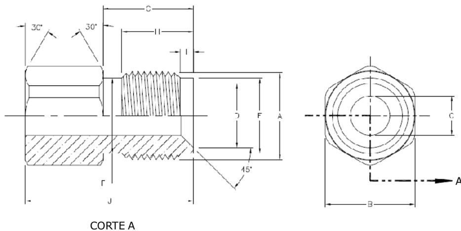
**Figura 9. EXT derecha para Conexión integral flexible**
