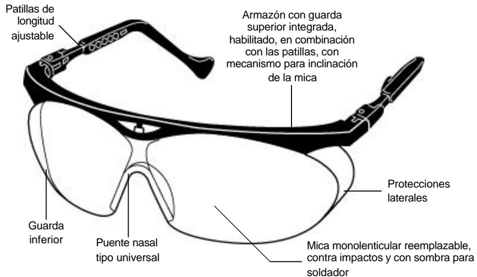
**Figura No. 4.** Tipo 4 de la Tabla No. 1, contra impactos y para soldador. Secciones 8.2.1. y 8.2.3. Pueden diseñarse para alojar micas duales Rx como la de la Figura No. 11.
