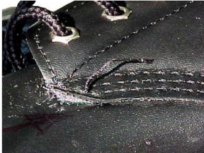
*Figura No 40. Descosadura.*
