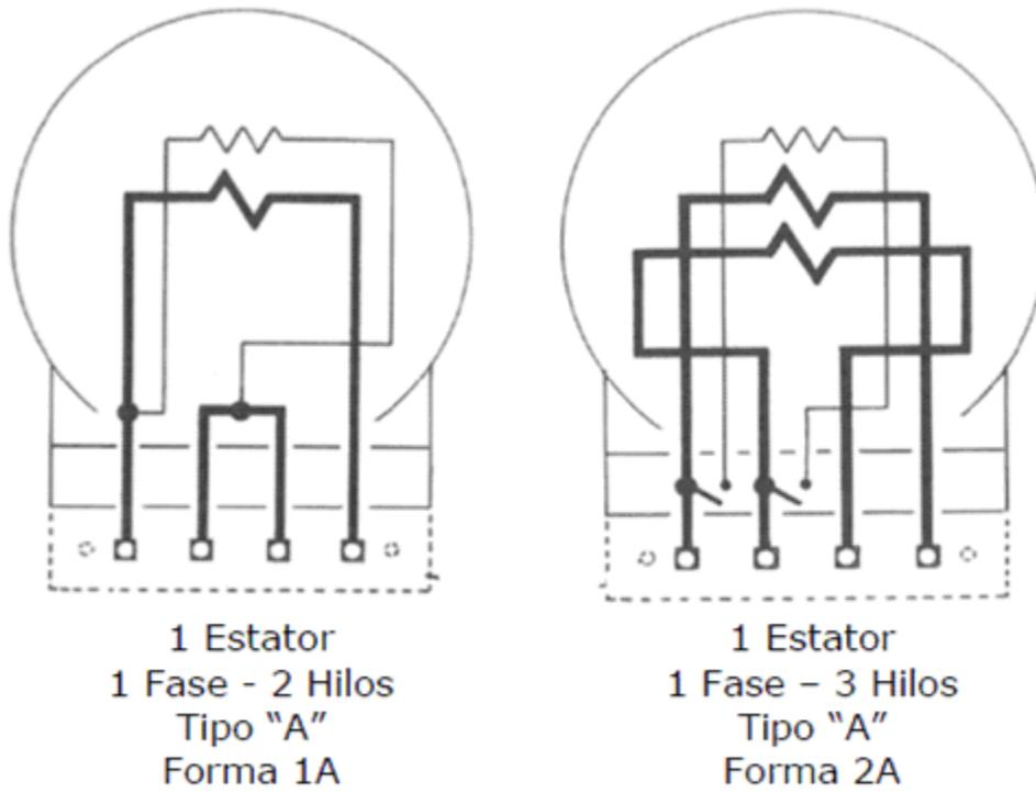
Figura 3 - Conexiones internas para wathhorímetros tipo "A" monofásicos (vistas frontales)
