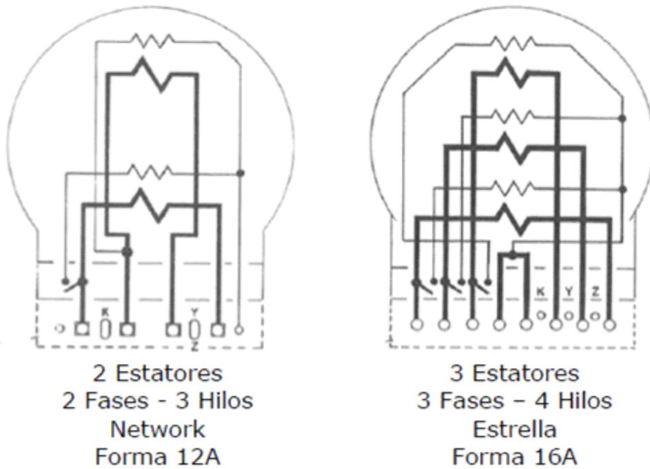
Figura 4 - Conexiones internas para wathhorímetros, autocontenidos tipo "A" de varios estatores (vistas frontales)
