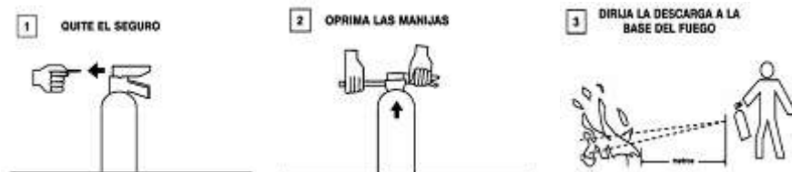
Figura 3-Ejemplo de imágenes y leyendas que ilustran la nemotecnia de operación de los extintores portátiles
