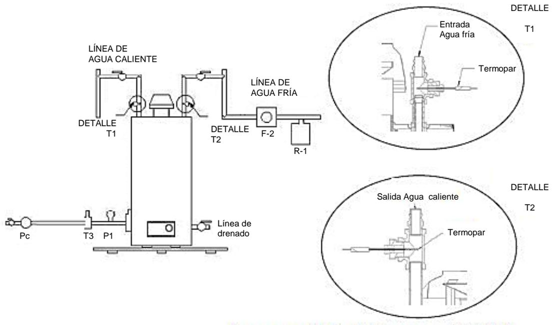
**FIGURA 2–Calentador de rápida recuperación (ilustrativa no limitativa)**
