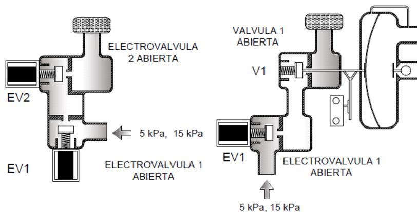
**FIGURA 6 c)-Prueba de hermeticidad para el total de las válvulas del subensamblaje para el corte de gas (ilustrativa no limitativa)**
