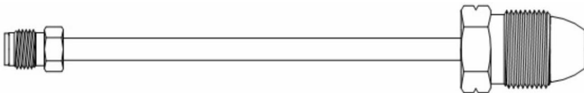
FIGURA 1-Conexión integral (cola de cochino) Tipo 1 (ilustrativa no limitativa)
