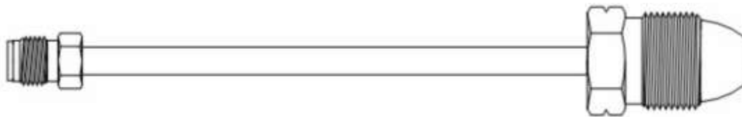
Figura 1-Conexión integral (cola de cochino) Tipo 1 (Ilustrativa)
