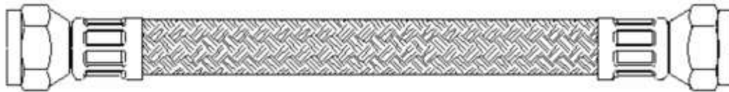
Figura 3-Conexión flexible Tipo 3 (Ilustrativa)
