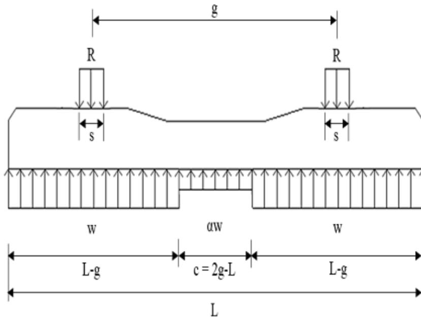
**Figura 3. Suposiciones de Carga y Condiciones de Soporte**
