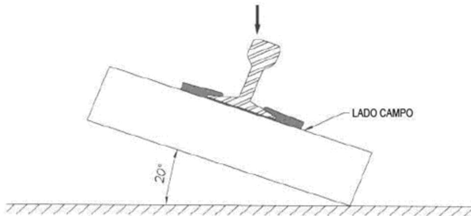
Figura 15. Prueba de carga repetitiva de la fijación
