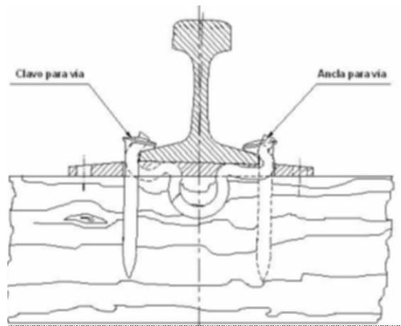
**Figura 4. Sistema de fijación en vía clásica**
