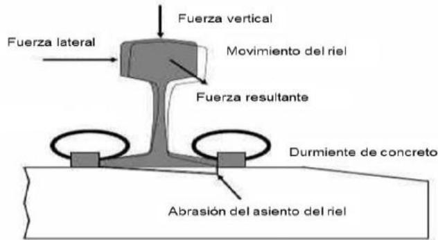
**Figura 16–Desgaste de durmiente**
