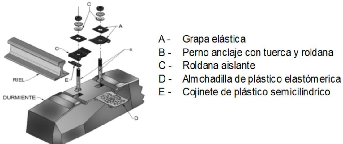
**Figura 5. Sistema de fijación en vía elástica**
