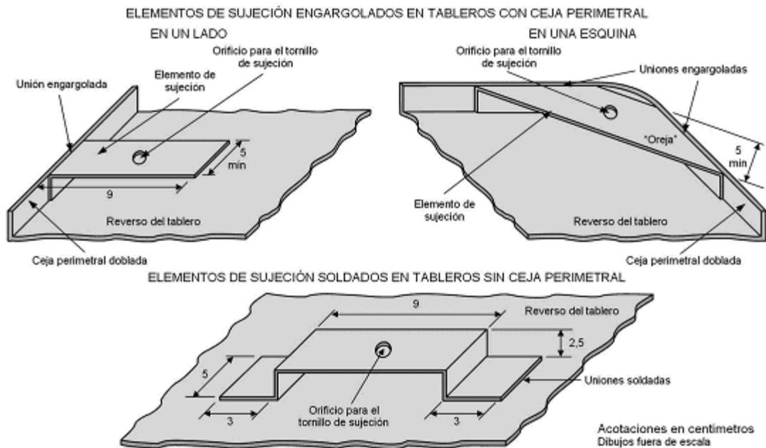
FIGURA 35.- Elementos de sujeción para señales bajas
