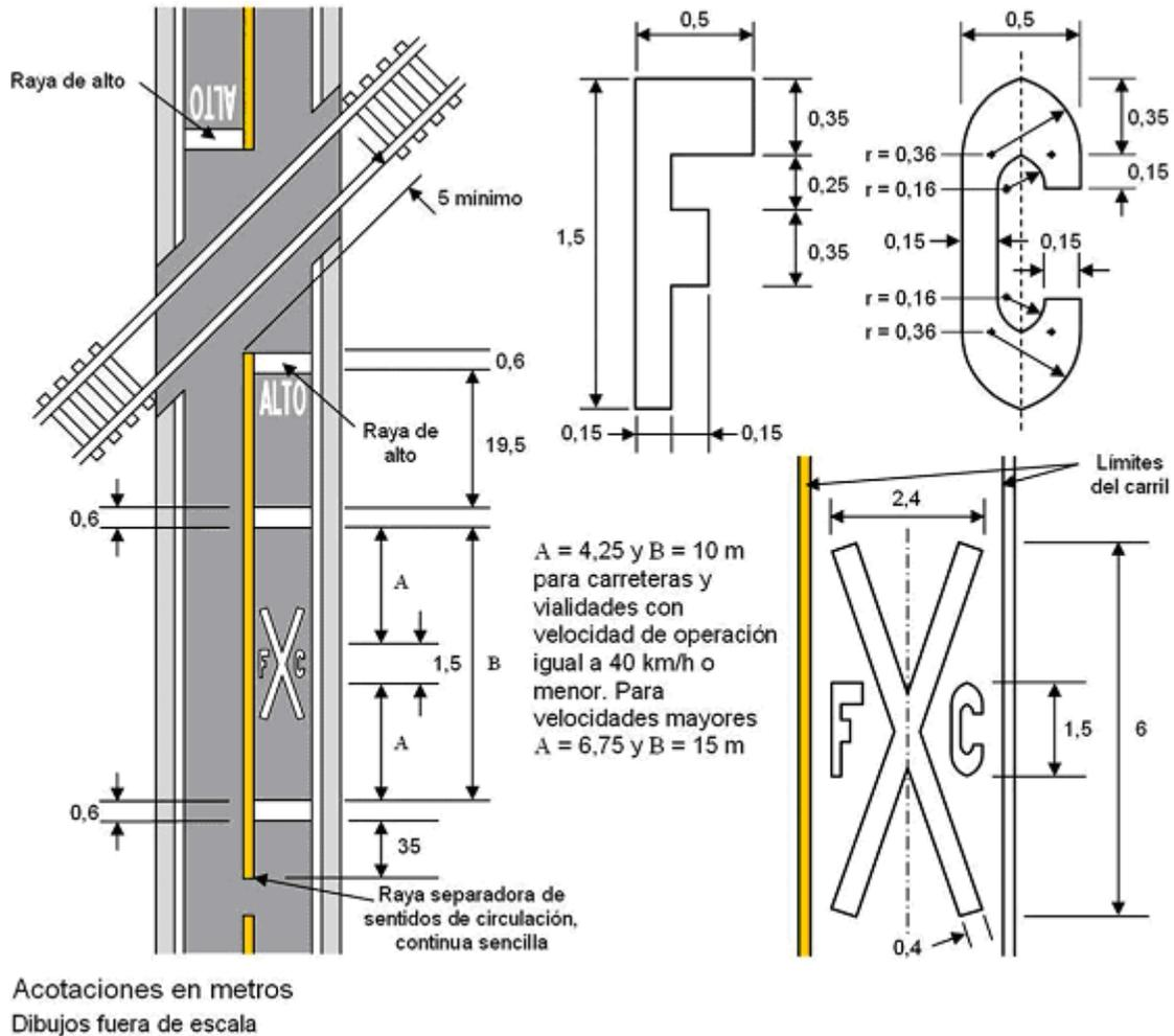
FIGURA 11.- Marcas para cruce de ferrocarril (M-8)
