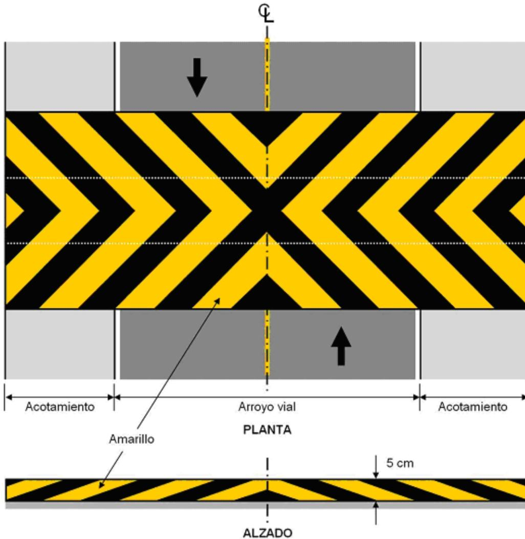
FIGURA 27.- Color de los reductores de velocidad (RV)
