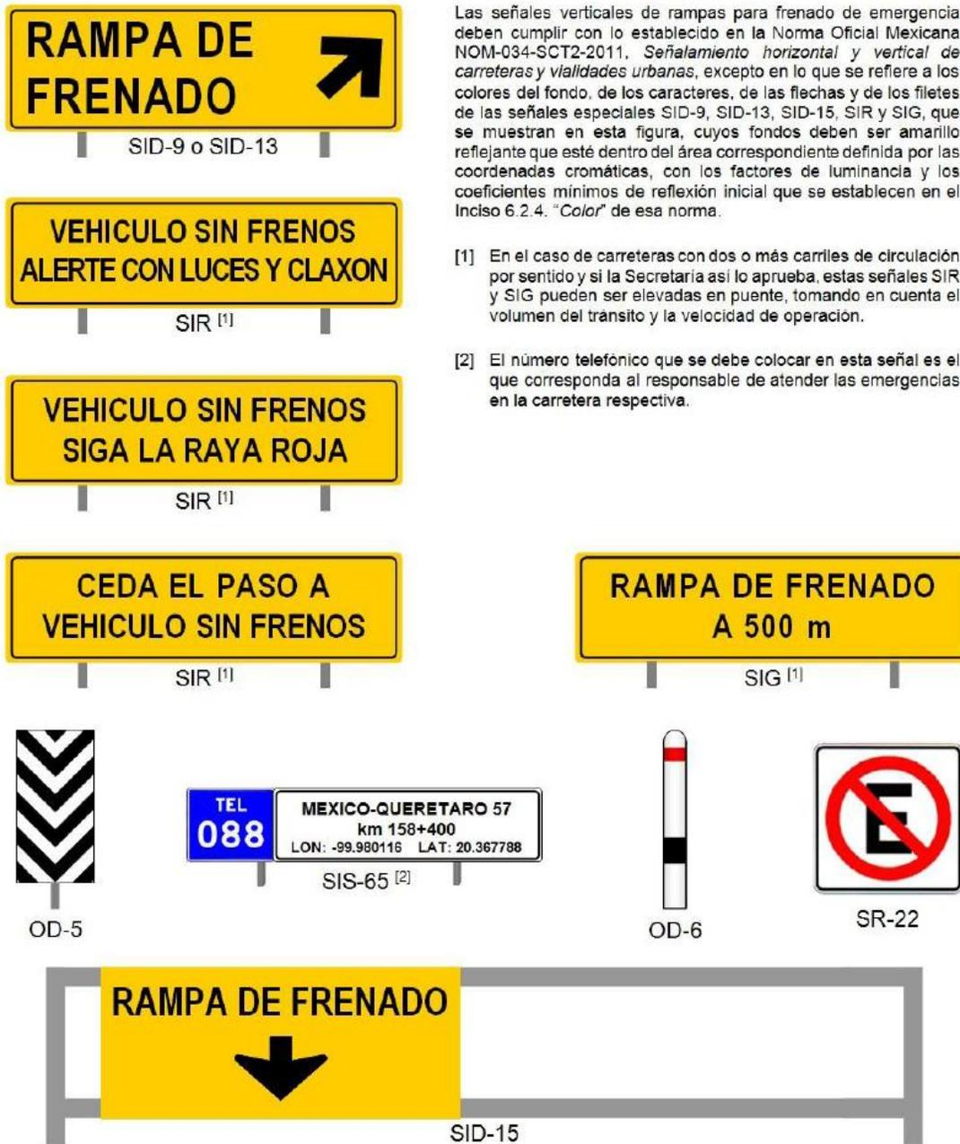
Figura 8.- Señales verticales de rampas para frenado de emergencia
