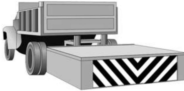
FIGURA 9.- Ejemplo de amortiguador de impacto móvil (OD-14/M)
