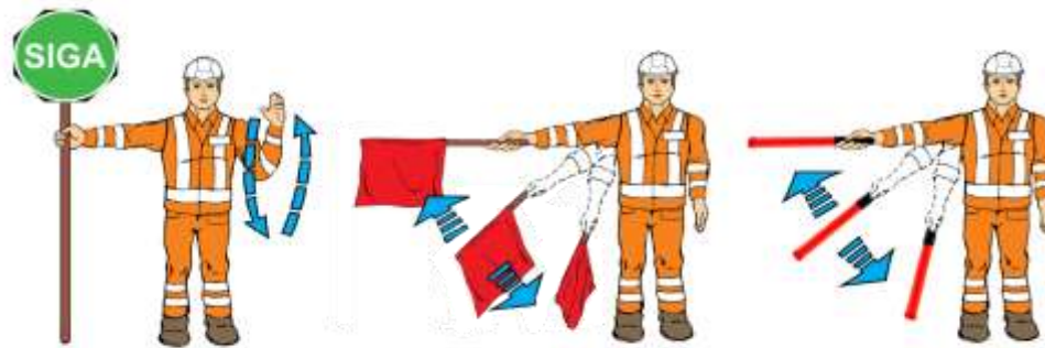
Alertar y disminuir la velocidad del tránsito
