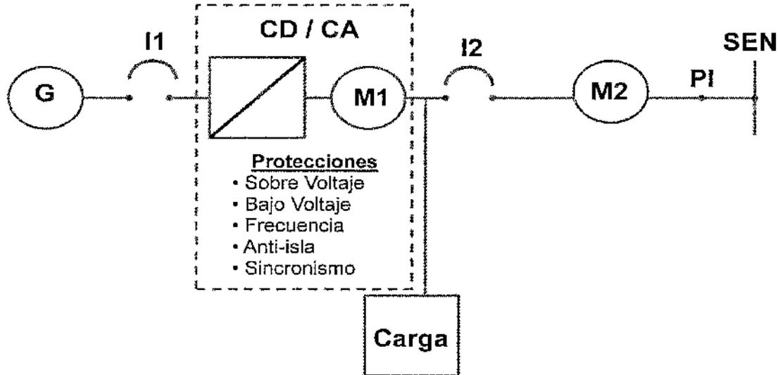
Figura 1. Esquema para la interconexión de generación en pequeña escala.
