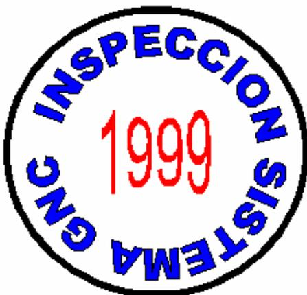
**Figura 13.**-Etiqueta de inspección exterior visual de los cilindros y sujeción una vez al año. En el anverso llevará código de barras indicando el perito que hizo la inspección. La cual debe ser otorgada por la autoridad competente.
