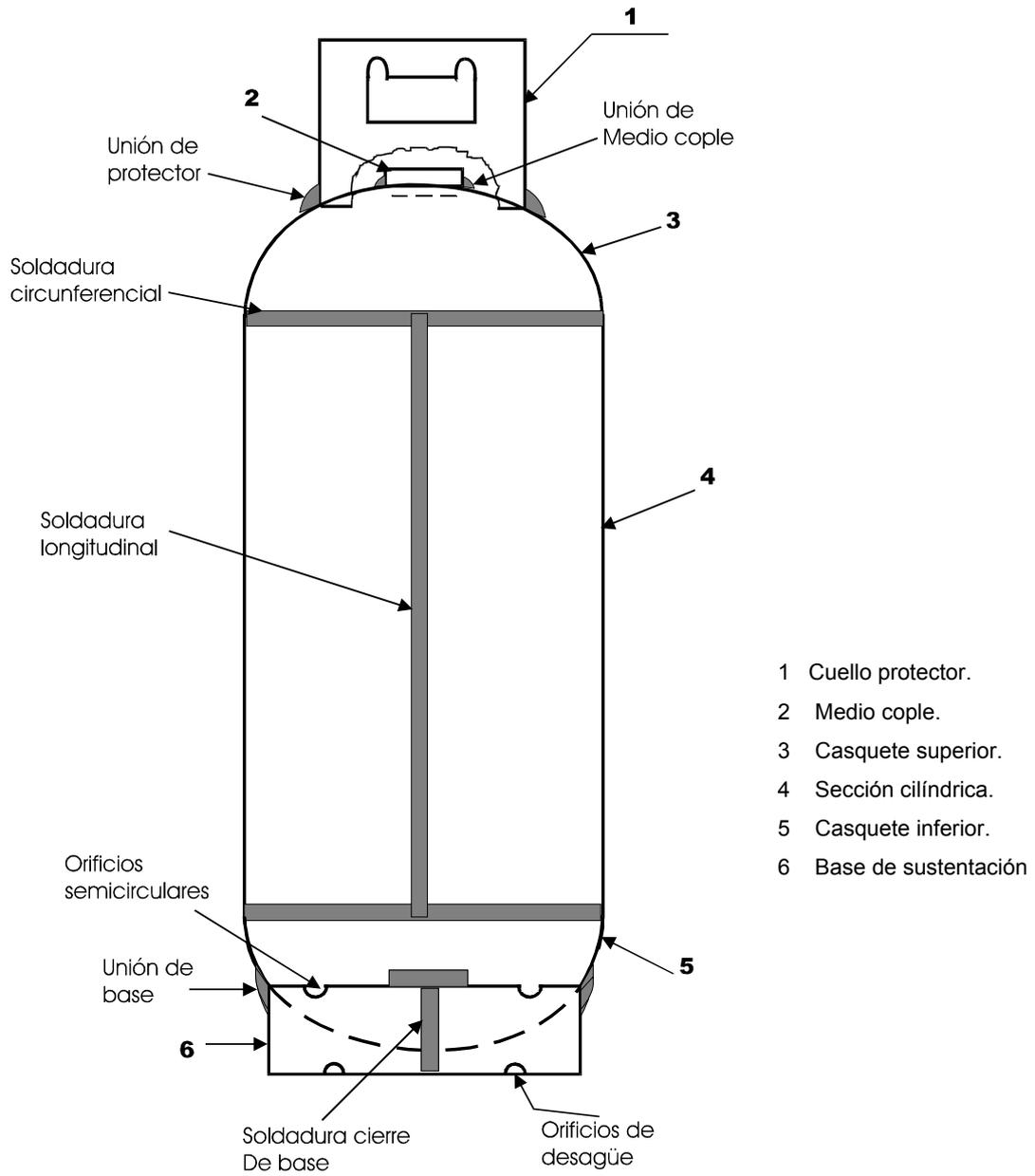
**Figura 1: Recipiente portátil para gas L.P. tipo A**
