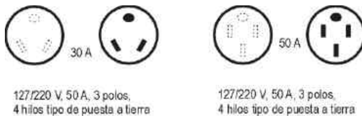
Figura 552-44 (c) d) Etiquetado en la entrada eléctrica. Cada remolque debe tener permanentemente fija en su cubierta exterior, en o cerca del punto de entrada del conjunto alimentador, una
