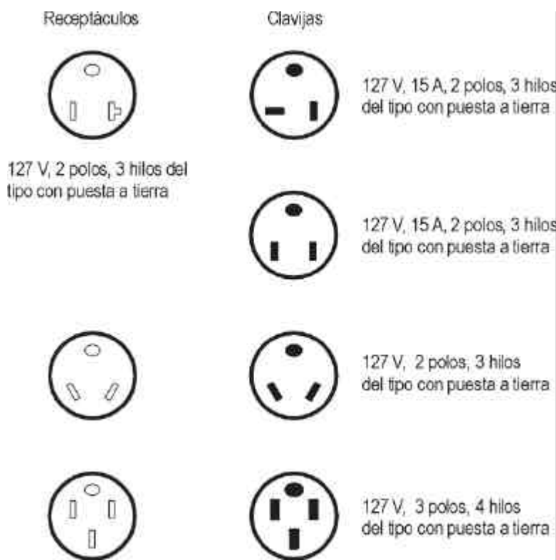
Figura 551-46 (c) receptáculos y puesta a tierra cordones para recreo y sus
