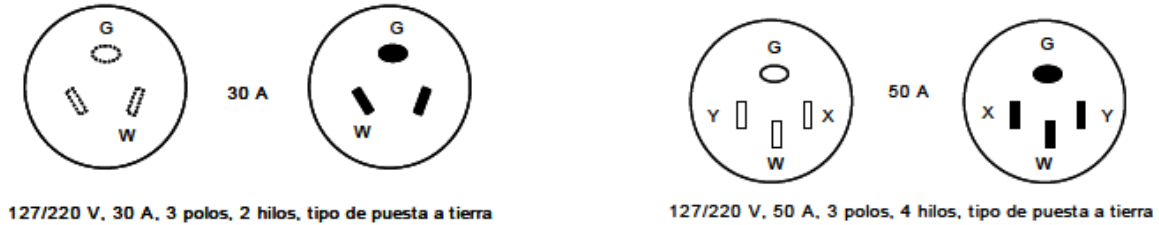
FIGURA 552-44(c).- Configuraciones para contactos y clavijas del tipo con puesta a tierra
