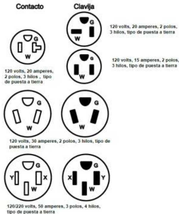
Figura 551-46(c)(1).- Configuraciones para contactos y clavijas de conexión del tipo puesta a tierra utilizadas con los cordones de alimentación de los vehículos de recreo y sus estacionamientos
