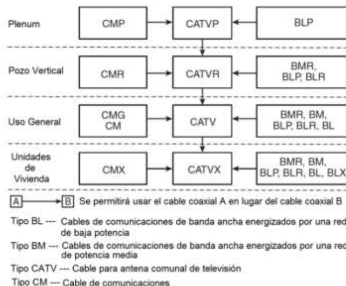
Figura 820-154.- Jerarquía de sustitución de cables
