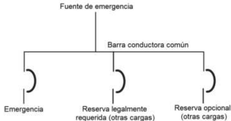
Figura 700-10(b)(5)(b)(1).- Alimentadores simples o múltiples sin protección contra sobrecorriente
