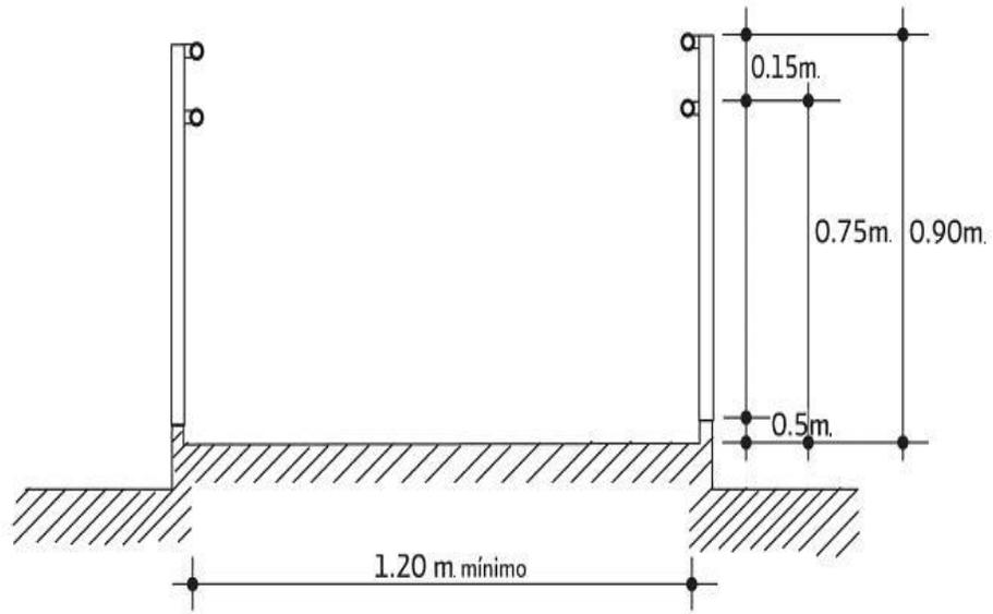
Figura A.3 Esquema de los descansos de una rampa.
