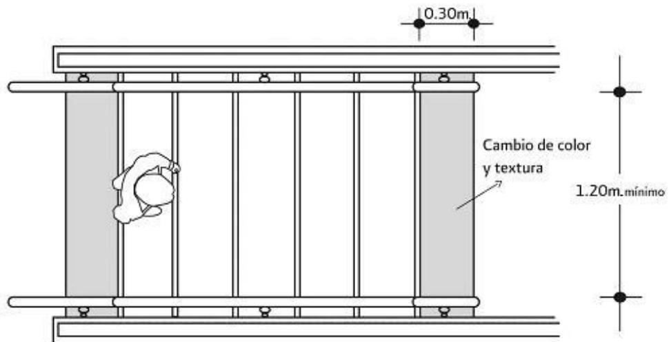
Figura A.5 Esquema del área interior y exterior de un elevador.
